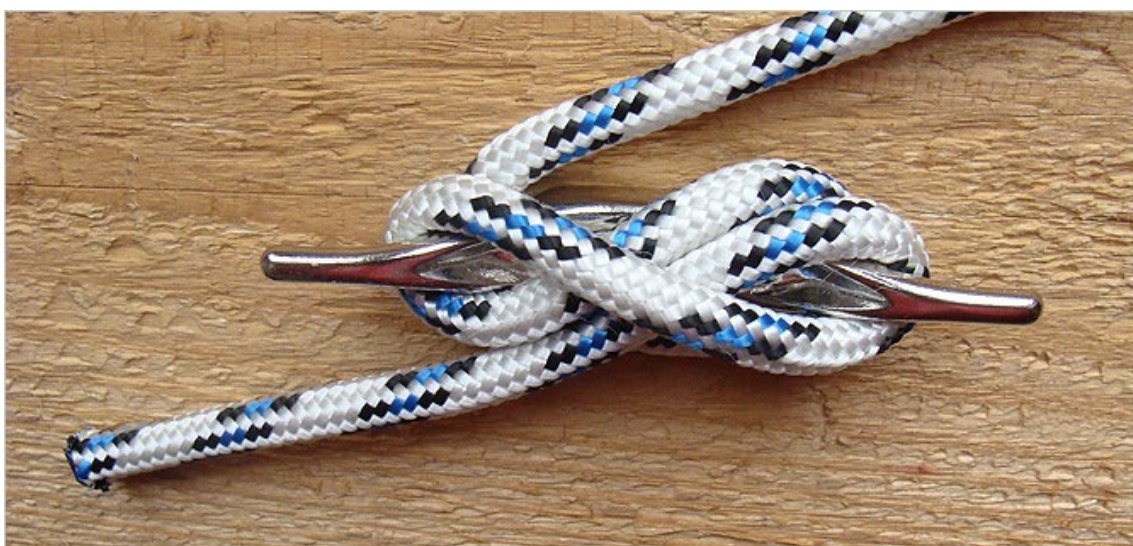
Węzeł knagowy - Jak sama nazwa wskazuje, służy do obkładania szotów, fałów, cum na knadze.
